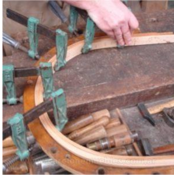
Figura 92: Molde de madera para curvar madera, contra molde de prensas manuales
