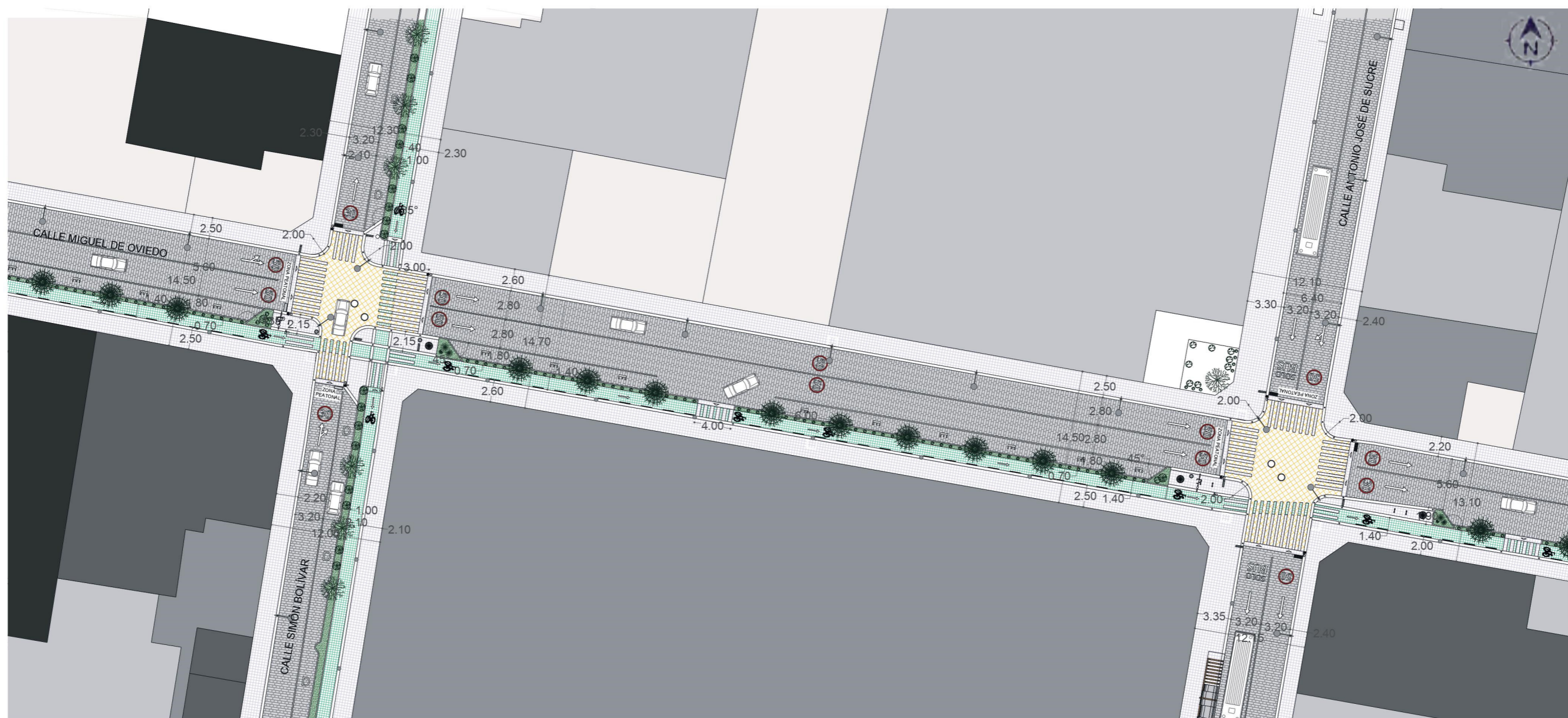
(Figura 192), Diseño de movilidad alternativa en calles Miguel de Oviedo, Simón Bolívar y Antonio J. de Sucre, carriles de vehículos livianos, zonas DUM y zonas 30 km/h con ciclo vía segregada.
