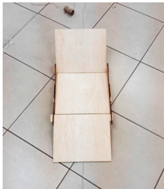
Figura 30 Sosa, G. 2023. Base de los robots hecha con madera triplex 4 mm y cortada a laser.
