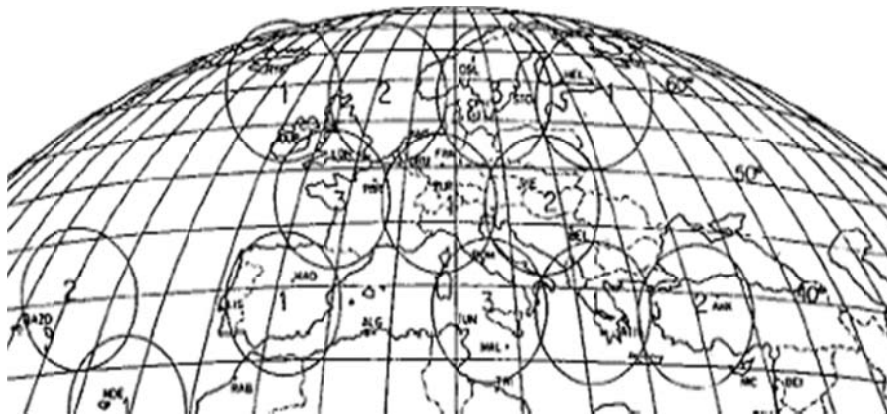
Figura 13. Reutilización de frecuencias de una antena multihaz.
