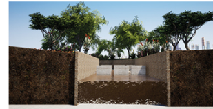
Imágen 51: Disipadores de energía a base de hormigón (Avilés, M.; 2022)
