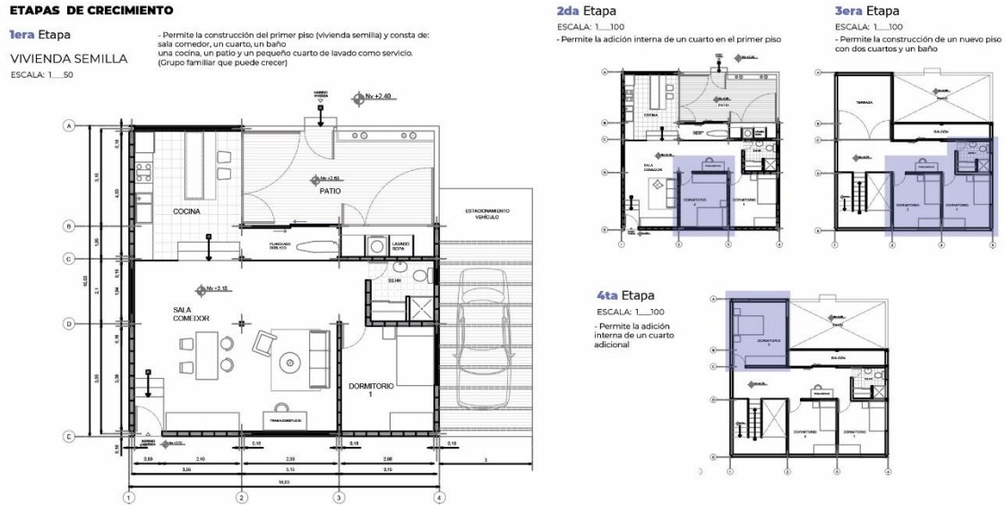
Figura 31: Planta Tipología de vivienda de 10 m 2
