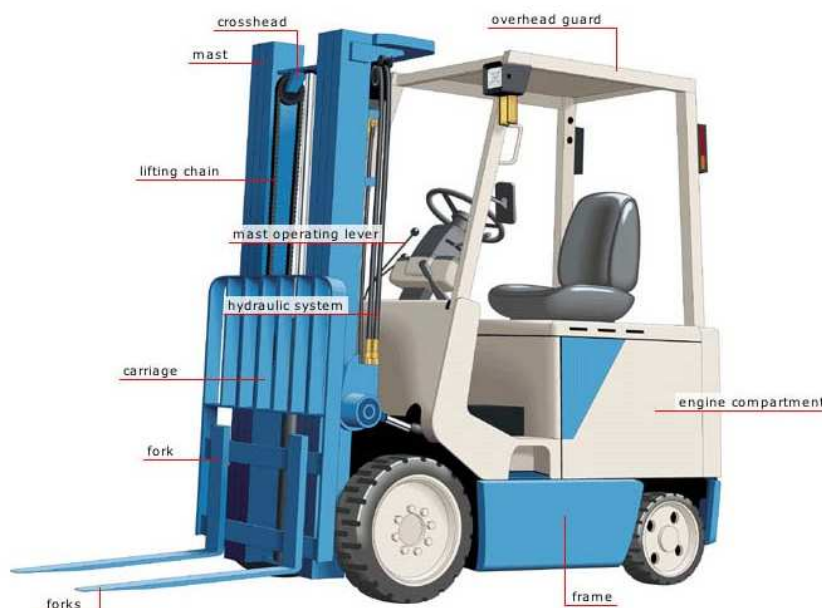
Gráfico No. 4.5: Partes de un Montacarga
