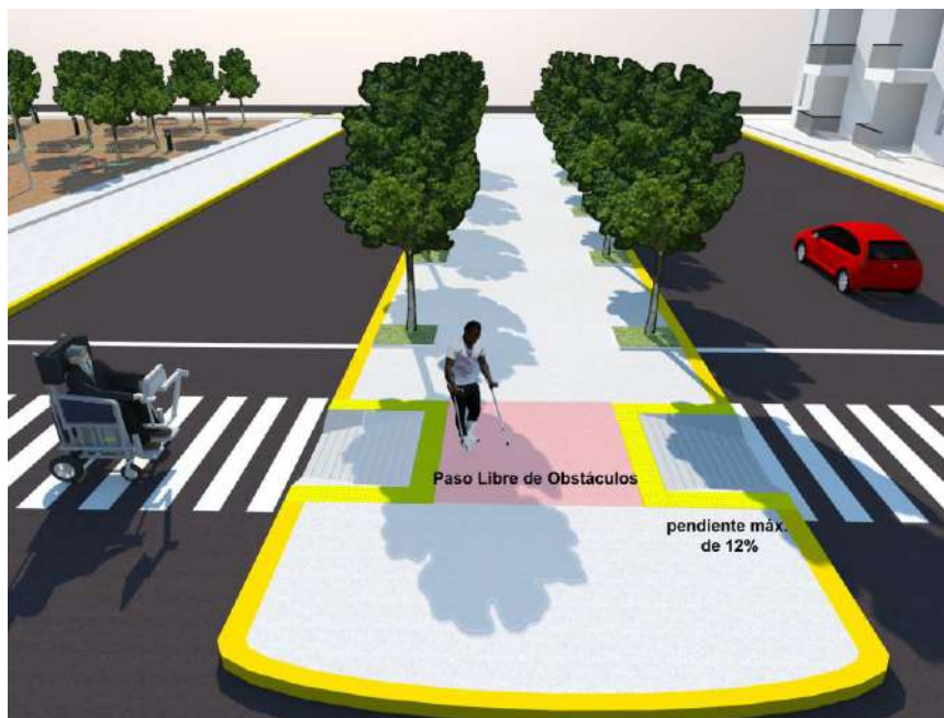
FIGURA 11. Detalle de calzadas y parterre central en donde el desnivel existente entre estas se salva mediante vados
