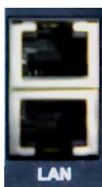
Detalle de conectores LAN (inferior) y ETHERNET (superior)
