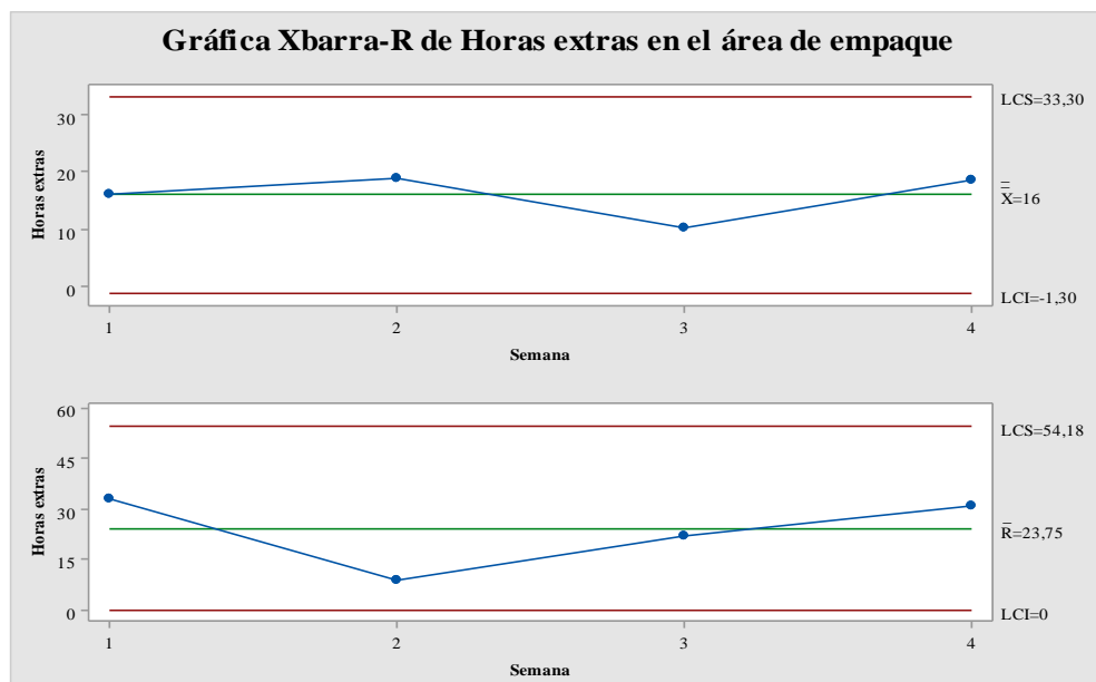
Figura 66. Diagrama de Xbarra y R en horas extras generadas después de las mejoras en el área de empaque
