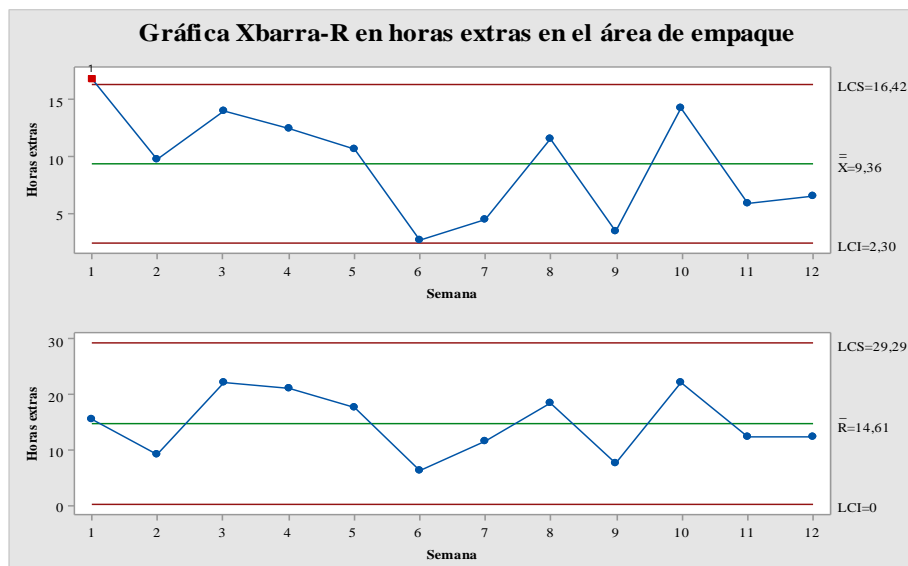
Figura 40. Diagrama Xbarra y R en horas extras generadas en el área de empaque
