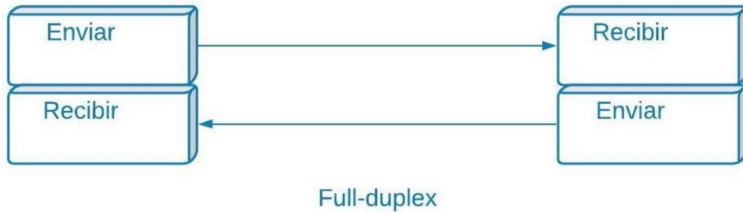
Figura 3. Modo de transmisión full-duplex [16]
