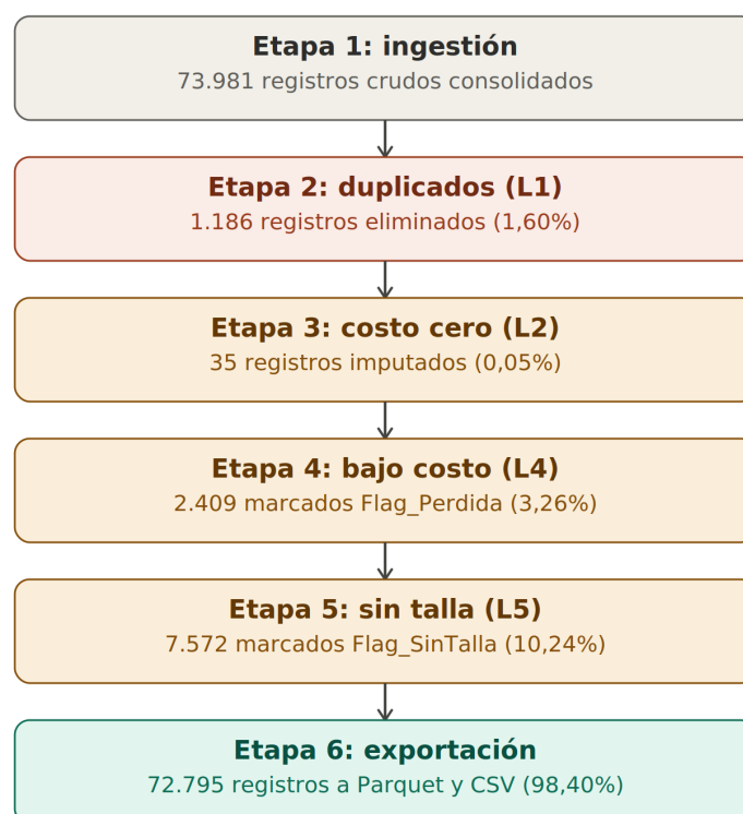
Figura 3.1. Diagrama de las seis etapas del pipeline ETL.
