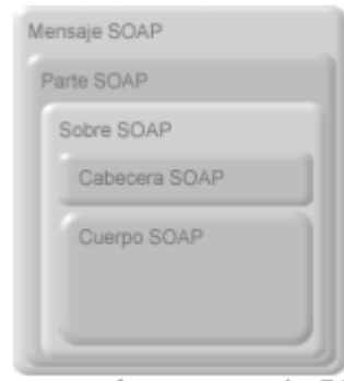
Ilustración 11. Elementos de un mensaje SOAP. Fuente: Universidad de Alicante (2013). Departamento de computación e Inteligencia Artificial.
