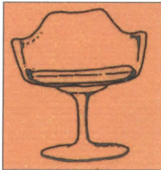
Sillón Saarinen (1958). El asiento, respaldo y brazos de una sola pieza en plástico moldeado reforzado con fibra de vidrio, descansan sobre una base de aluminio fundido como pedestal. Para mayor comodidad, el asiento está cubierto con un delgado almohadón de goma, forrado de tela.
