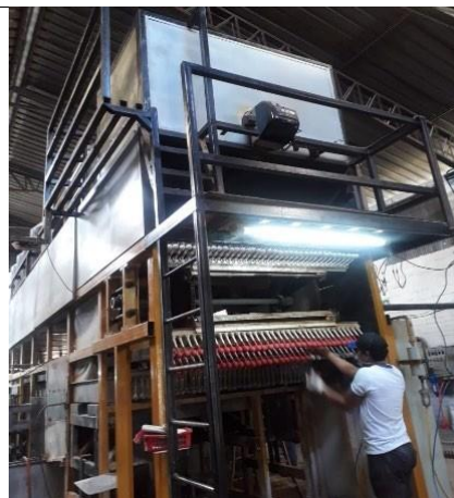
Ilustración 8: Desmoldado de globos
