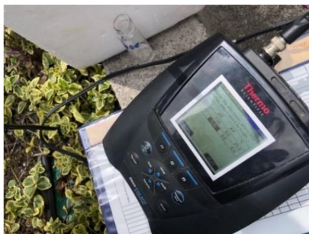
Fotografía 6. Calibración de potenciómetro, Envirnovalab, Conocoto, 2022
