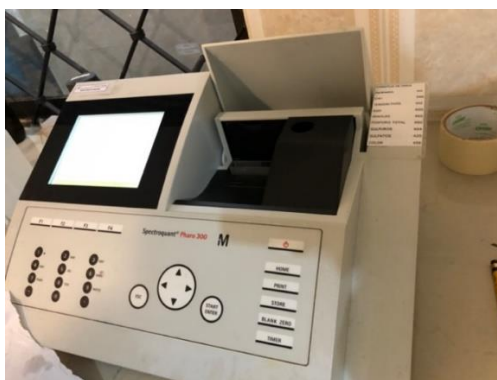
Fotografía 3. Equipo espectrofotométrico UV-VIS, laboratorio químico Envirnovalab, Sector el Condado, 2022
