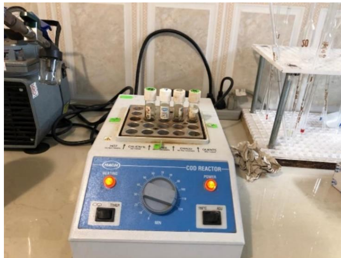
Fotografía 5. Reactor COD, laboratorio químico Environovalab, Sector el Condado, 2022
