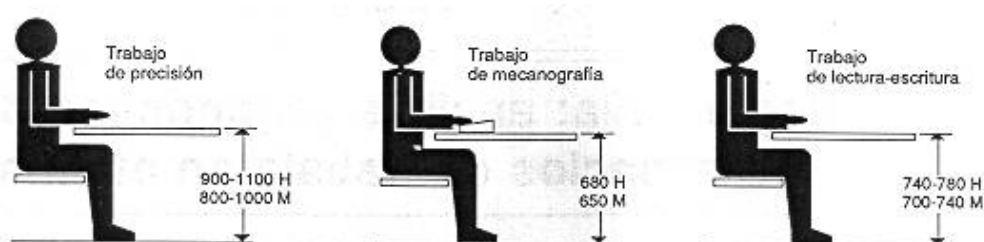
Imagen 2.2 Altura del plano de trabajo para puestos de trabajo sentado (cotas en mm). (Mc Cormick, 1980)
