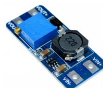
c. Elevador de tensión.
