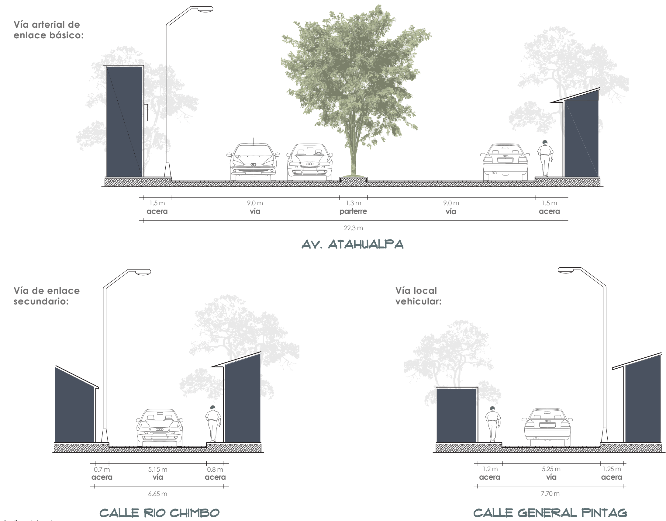
Figura 86. Corte de vías tipo del sector Fuente: Propia (2023)
