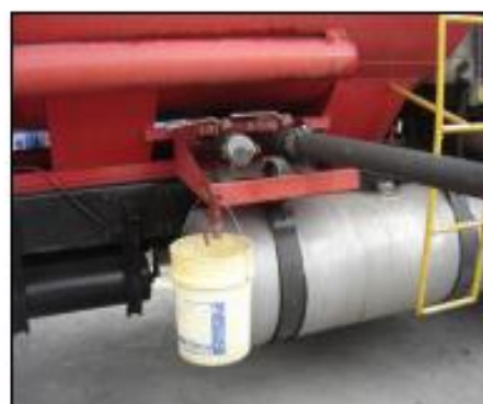
Foto 42. Durante la descarga se coloca una bandeja de recolección de goteo y un balde plástico como refuerzo
