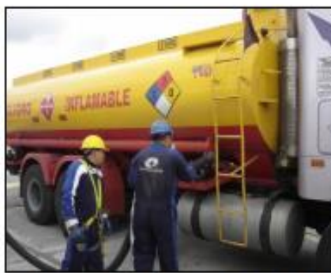
Foto 14. Procedimiento de acople de manguera al tanquero previo a la descarga
