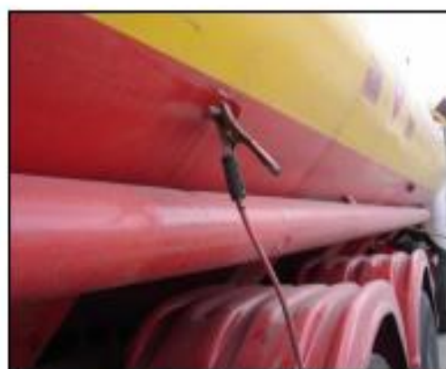
Foto 9. Toma a tierra colocada en el tanquero en el área de trasvase
