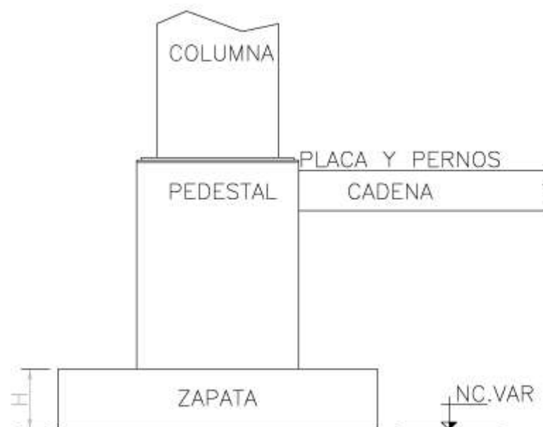
Fig. 21. Detalle de cimentación del edificio CIEI.
