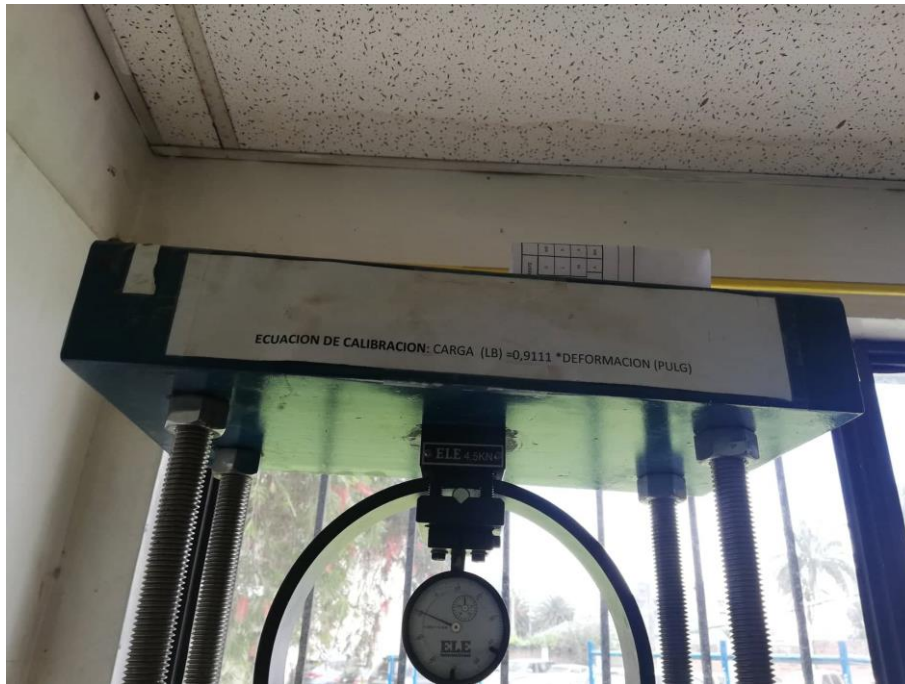
Ilustración 8.8. Ecuación de Calibración en ensayo de penetración CBR.
