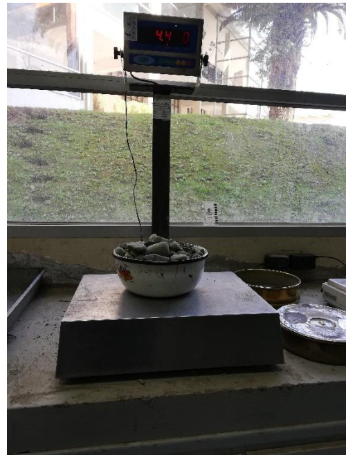
Ilustración 8.2. Muestra para Ensayo de Terrones de Arcilla.
