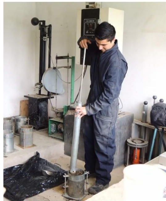
Ilustración 8.7. Compactación de Proctor Modificado.
