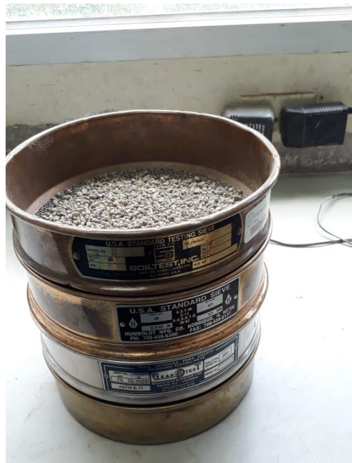
Ilustración 8.4. Muestra para Ensayo de Granulometría Fina.
