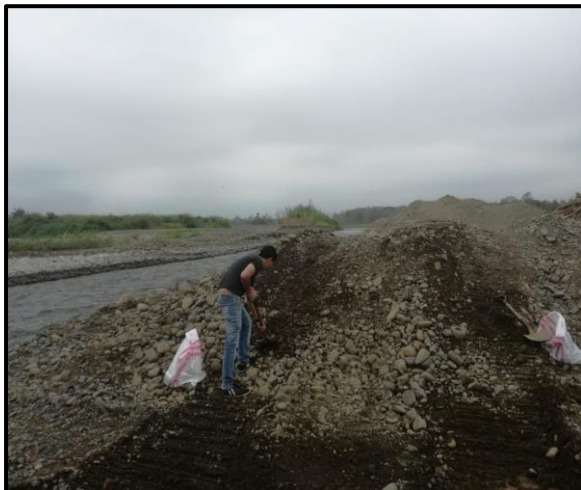
Ilustración 2.7. Muestreo de Agregados.
