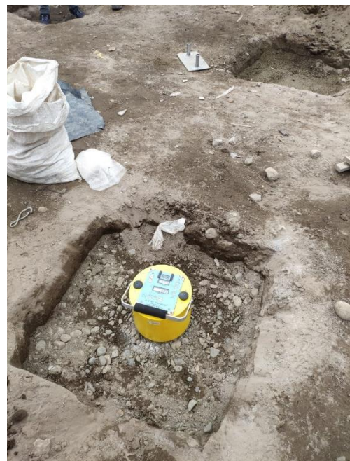
Ilustración 8.14. Medición de Módulos mediante equipo Geogauge.
