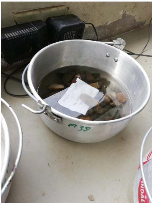
Ilustración 8.6. Preparación de muestra Desgaste a Sulfatos.
