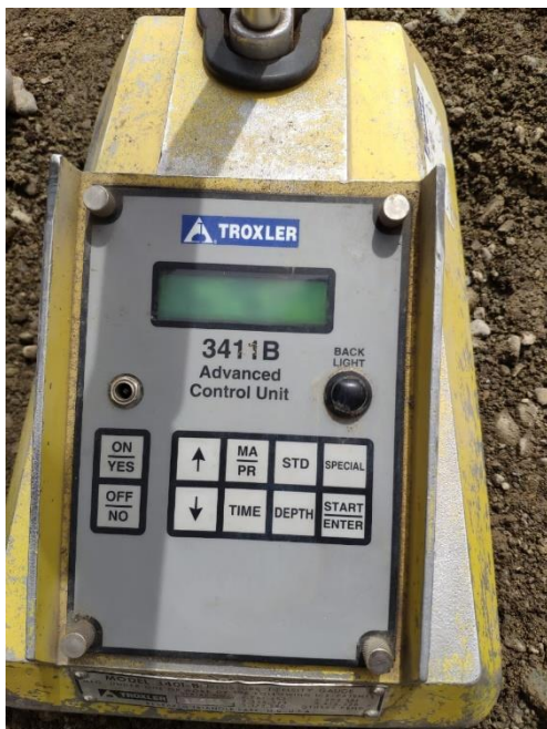
Ilustración 8.13. Medición de Densidades y Compactación con el uso del Densímetro Nuclear.
