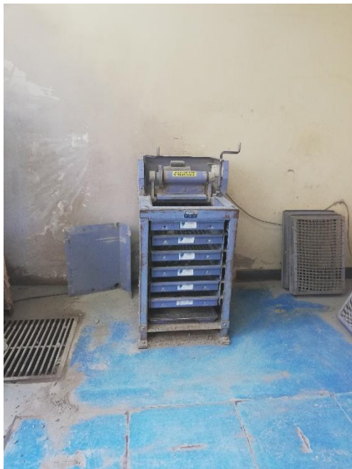
Ilustración 8.3. Ensayo de Granulometría Gruesa.
