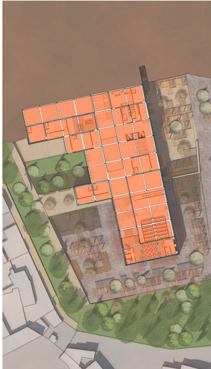
Ilustración 35: Planta nivel +3.60, modulación 6mx6m
