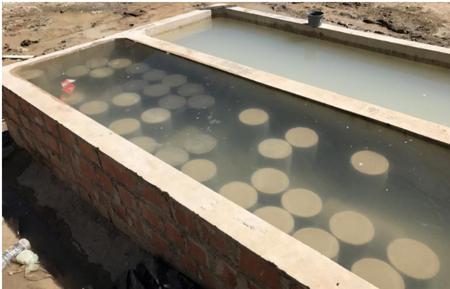
Gráfico 80: Piscina para cilindros de hormigón ubicados en la obra del proyecto. Fotografía por: J. Ponce. Fecha de la imagen: 20/05/2017.
