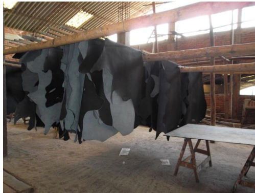
Imagen 2.67: Secado de la Pintura
