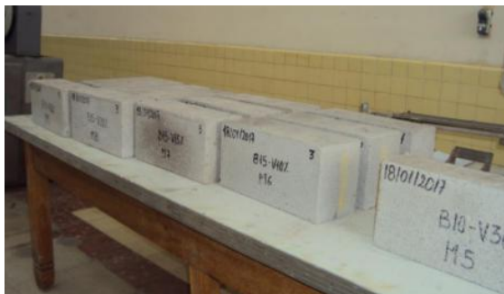
Figura 7. Bloques de aliviamiento con vidrio triturado
