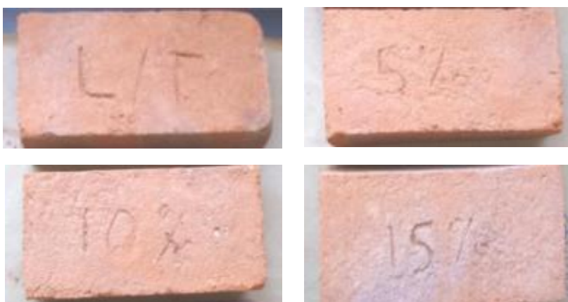
Figura 6. Ladrillos de arcilla elaborados con desechos de vidrio
