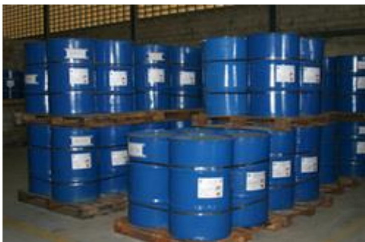
Figura 24. La ilustración muestra la forma correcta de apilamiento para residuos peligrosos.
