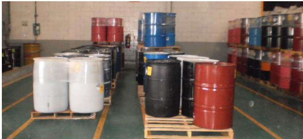
Figura 23. La imagen ilustra la manera adecuada de almacenar los residuos peligrosos dentro del área designada.
