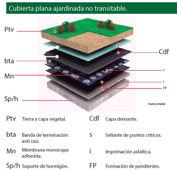
Gráfico 50: Capas de la cubierta verde
