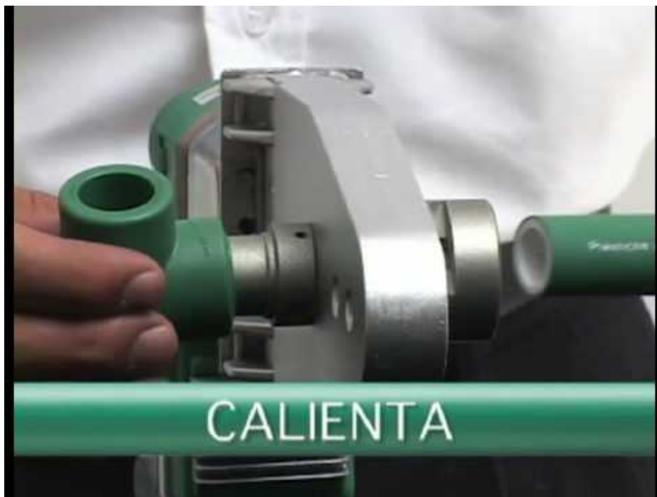
FOTO 5. Fotografía de proceso de termofusión con la termofusora.
