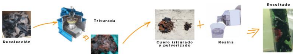
Figura 26: Proceso para la obtención del nuevo material con resina
