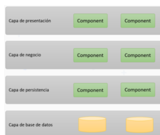
Figura 13 – Arquitectura en capas
