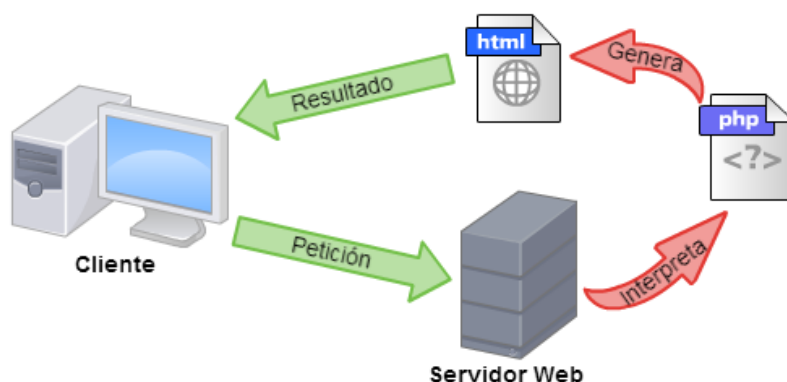
Figura 10 – Diagrama del funcionamiento de PHP
