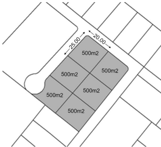
Figura 11. Configuración de lotes mínimos en el suelo rural Fuente: Elaboración propia en base a Información Catastral
