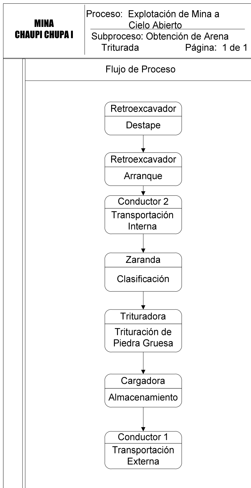
Gráfico 14: Flujo de Procesos Obtención de Arena Triturada
