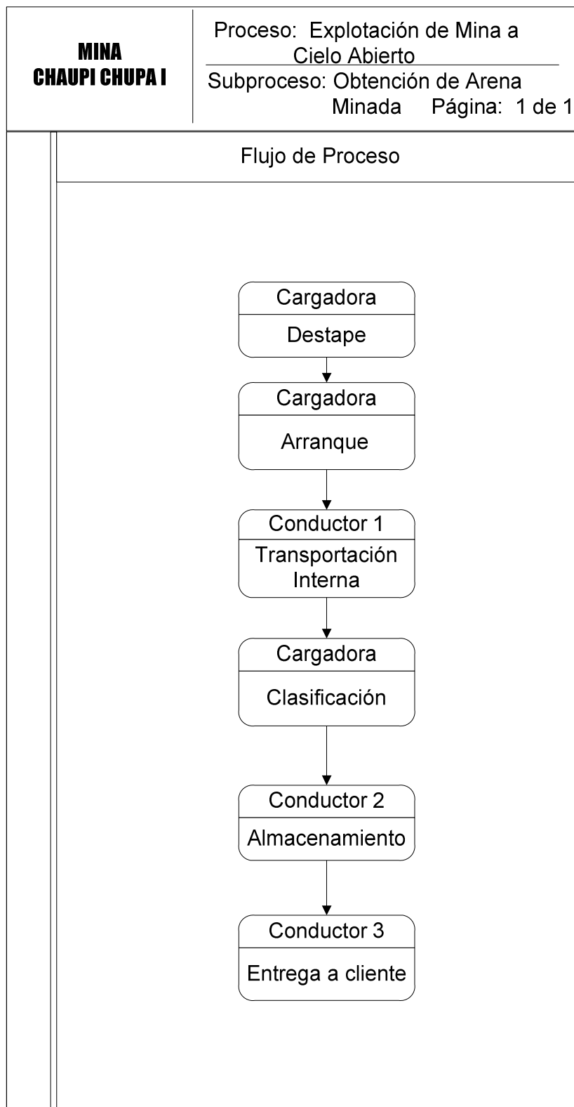
Gráfico 10: Flujo de Procesos Obtención de Arena minada
