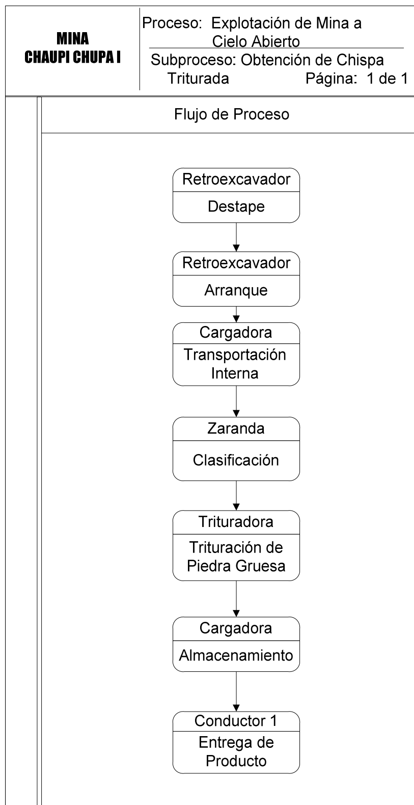
Gráfico 13: Flujo de Procesos Obtención de Chispa Triturada
