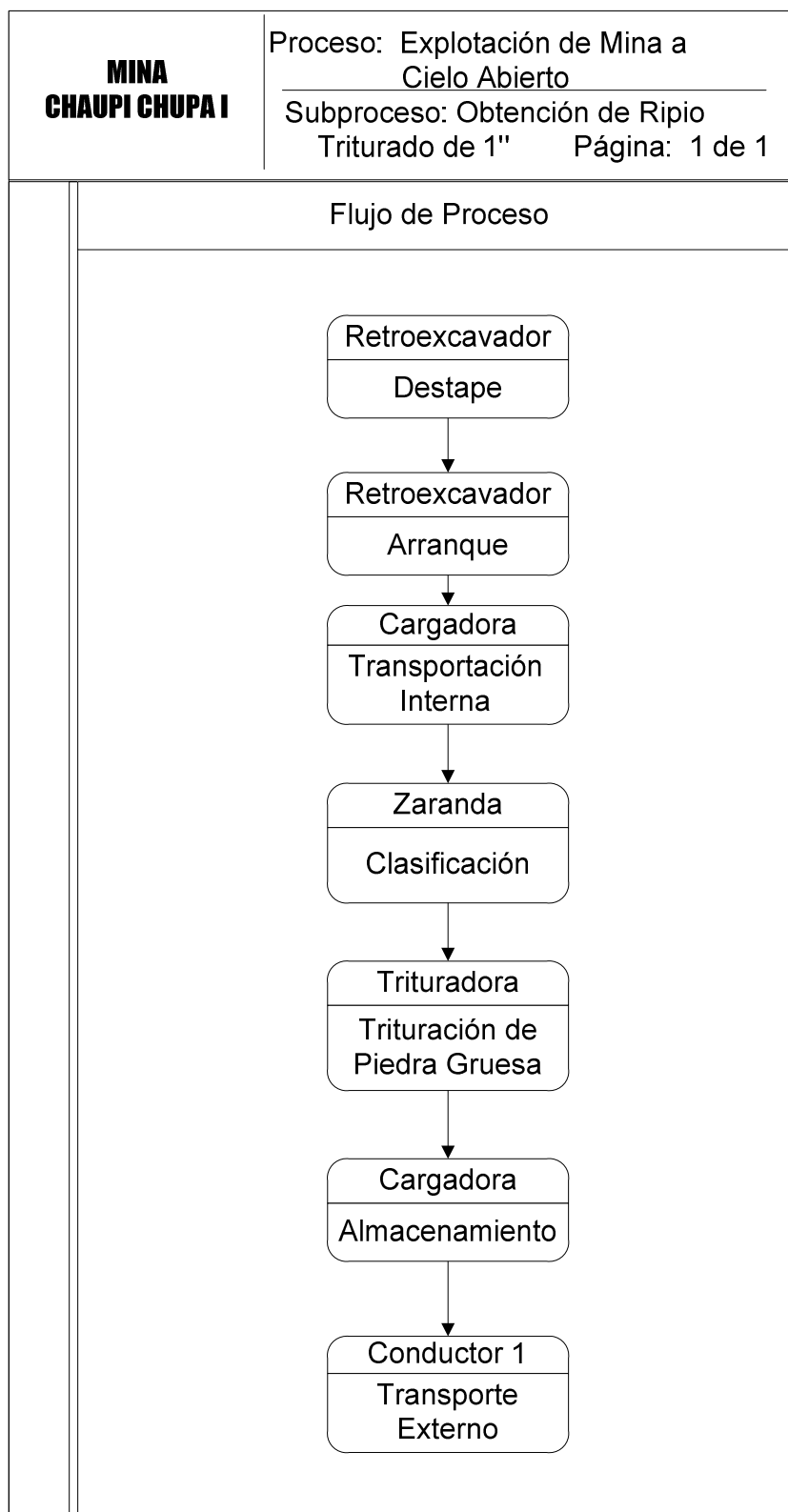
Gráfico 11: Flujo de Procesos Obtención de Ripio Triturado 1”
