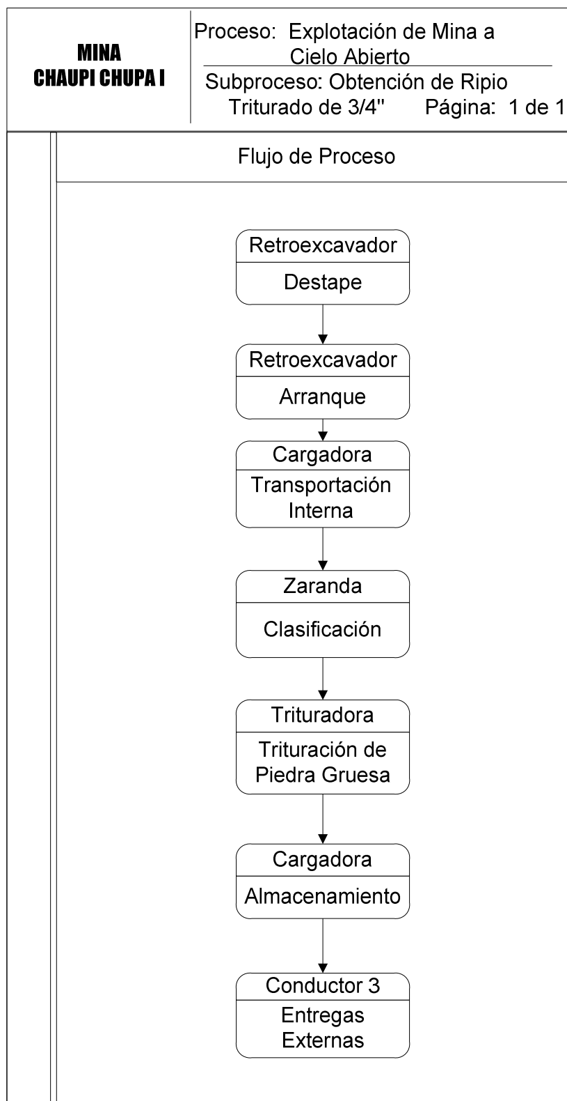
Gráfico 12: Flujo de Procesos Obtención de Ripio Triturado 3/4"
