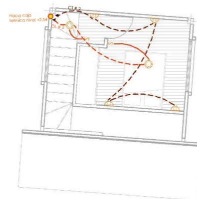
SEGUNDA PLANTA ALTA INSTALACIONES ELÉCTRICAS ESCALA: _____ 1:100
