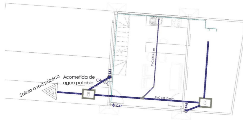
PLANTA BAJA INSTALACIONES HIDROSANITARIAS ESCALA: -----1:100
