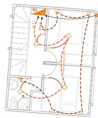
PRIMERA PLANTA ALTA INSTALACIONES ELÉCTRICAS ESCALA: _____ 1:100
