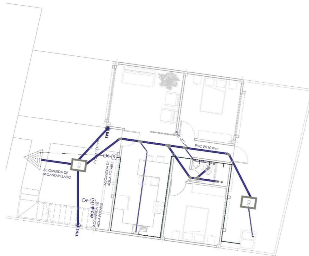
INSTALACIONES HIDROSANITARIAS PLANTA BAJA ESCALA: 1:100
