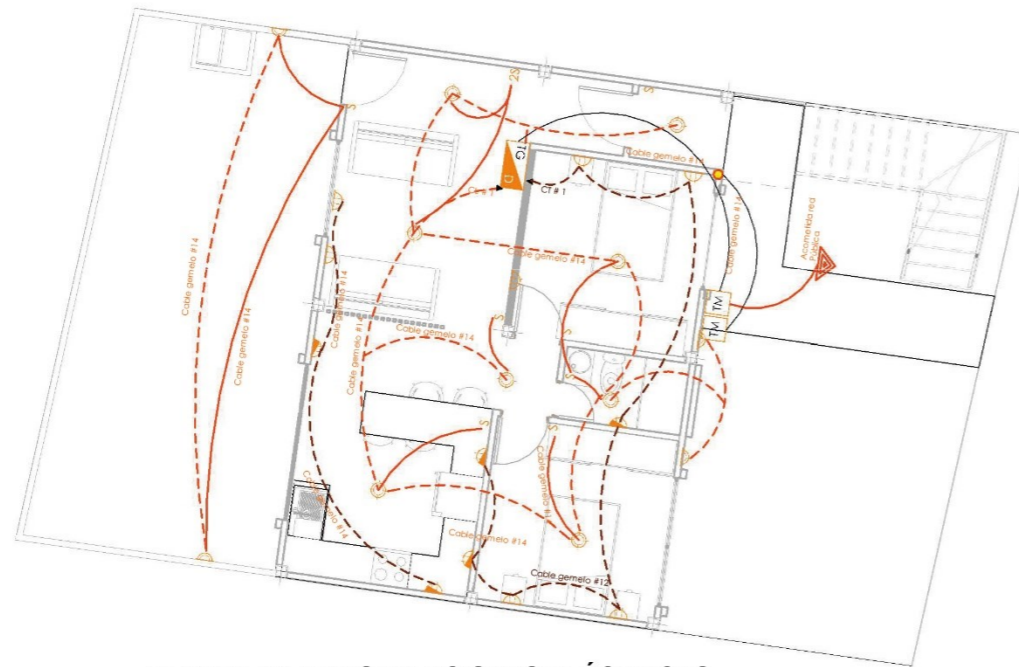
PLANTA BAJA INSTALACIONES ELÉCTRICAS ESCALA: 1:100
