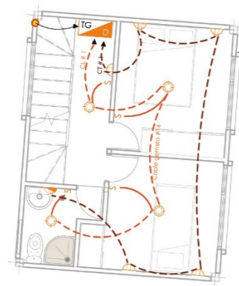
PRIMERA PLANTA ALTA INSTALACIONES ELÉCTRICAS ESCALA: _____ 1:100
