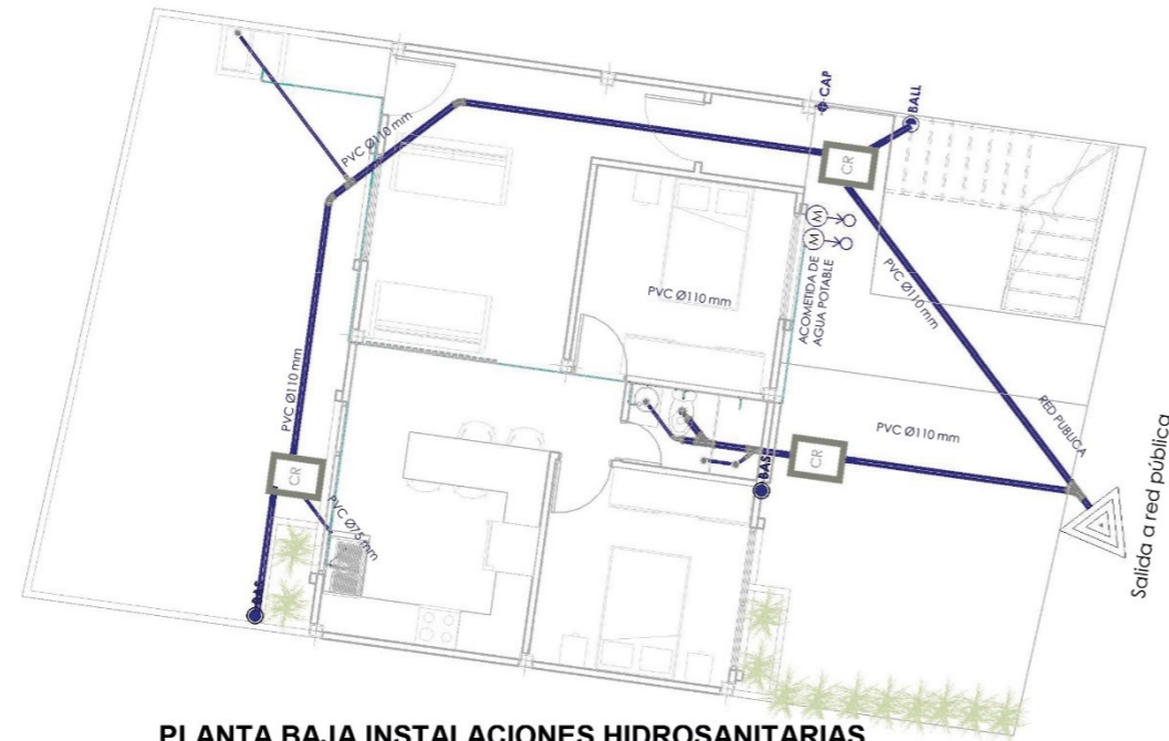
PLANTA BAJA INSTALACIONES HIDROSANITARIAS ESCALA: _____ 1:100
