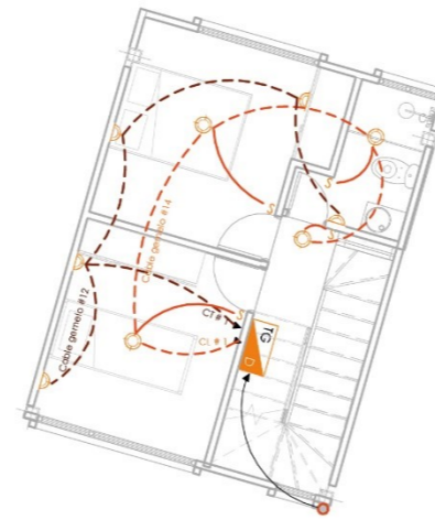
INSTALACIONES ELÉCTRICAS PRIMERA PLANTA ALTA ESCALA: 1:100
