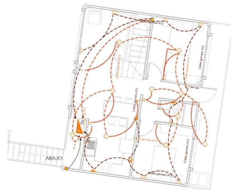
INSTALACIONES ELECTRICAS PRIMERA PLANTA ALTA ESCALA: 1:100
