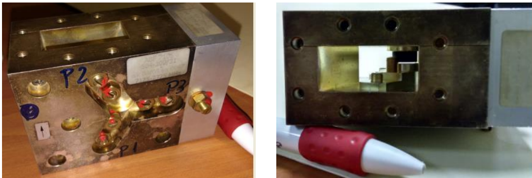
Gráfico 149. Circulator con carga acoplada en el puerto P3
