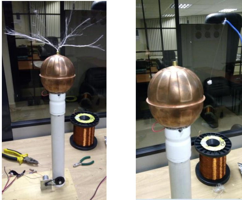
Gráfico 4. Generador de Campo Electrostático Construido para el Programa de Capacitación en Microondas. Los Hilos de Nylon se Separan (izq.); La Bolita Metálica es Atraída (der.)
