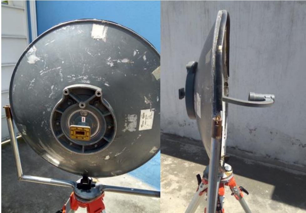
Gráfico 173. Antena parabólica en polarización VERTICAL
