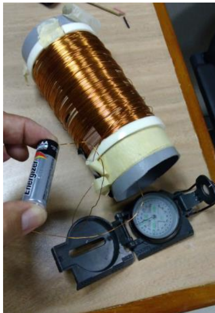
Gráfico 5. Solenoide Construido para el Programa de Capacitación en Microondas. La Aguja de la Brújula se Desvía del Norte.
