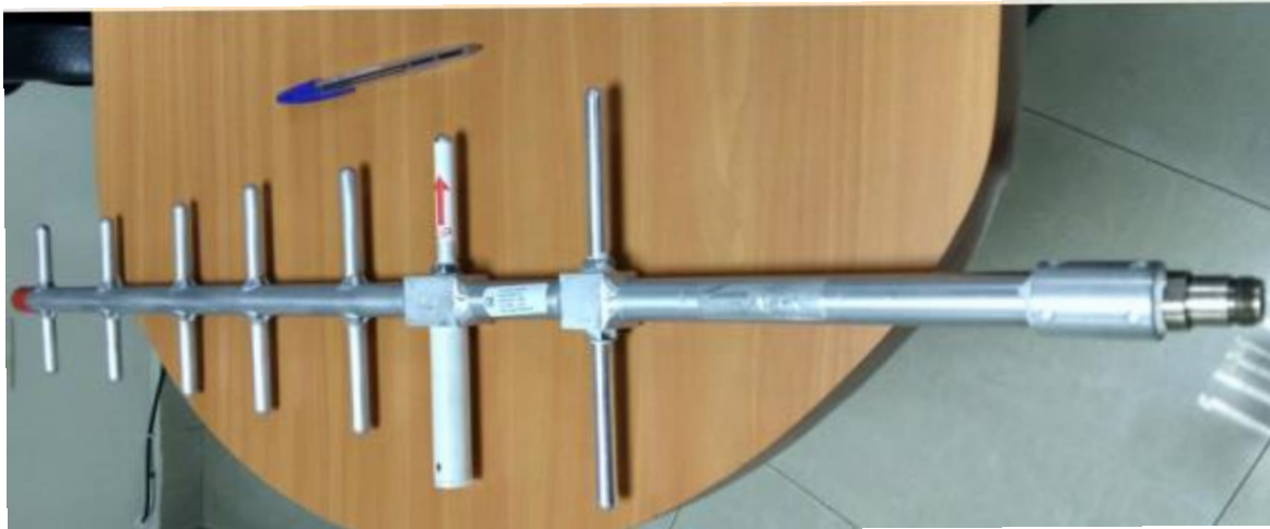
Gráfico 165. Antena Yagi de 800 MHz, ganancia 12 dB, conector N hembra.
