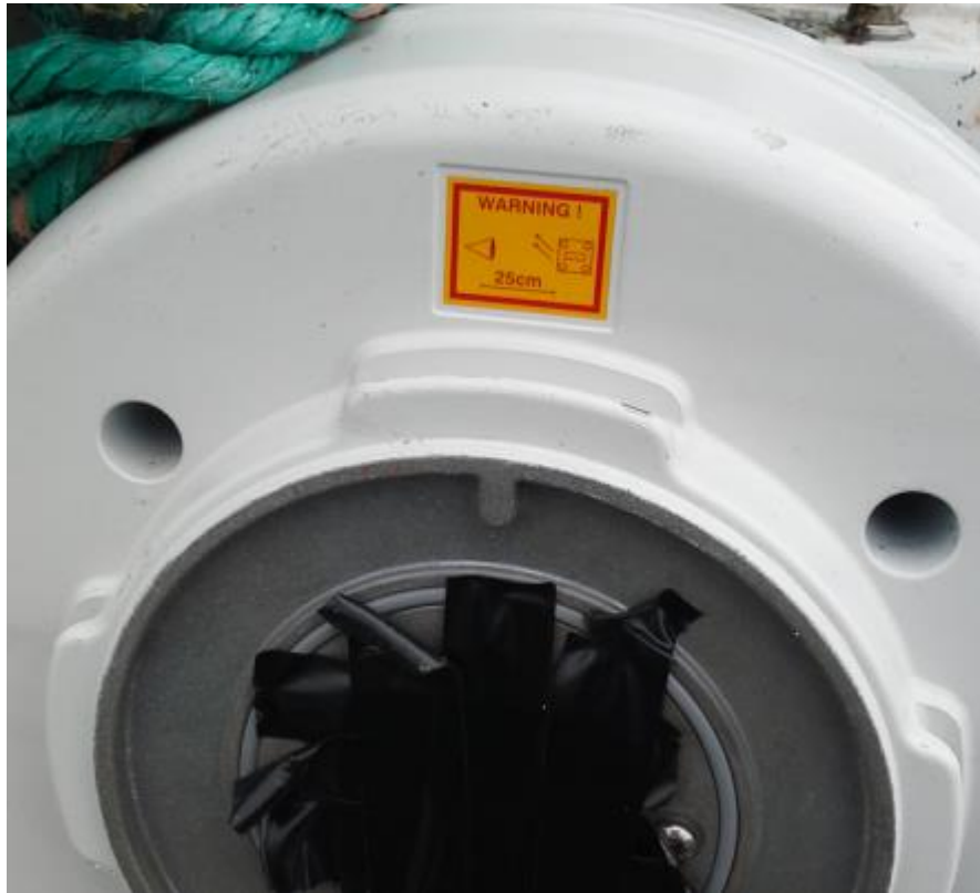
Gráfico 233. Precaución de radiofrecuencia, no mirar la salida de una ODU.
