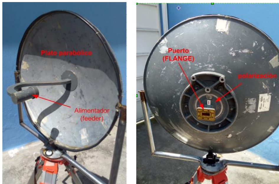
Gráfico 171. Antena parabólica estándar de 60 cm, 7 GHz
