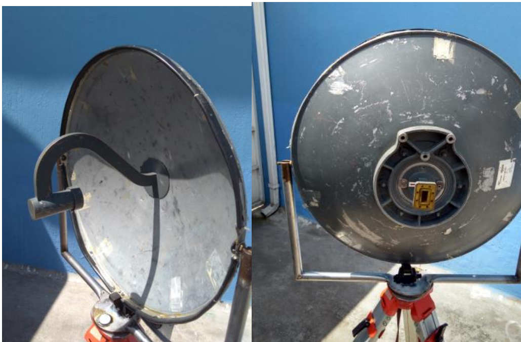
Gráfico 172. Antena parabólica en polarización HORIZONTAL
