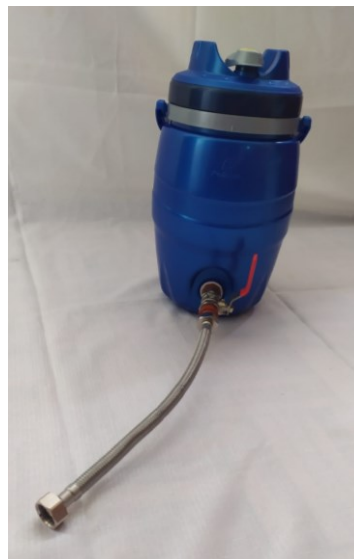
Imagen 14. Tanque de suministro de agua caliente armado
