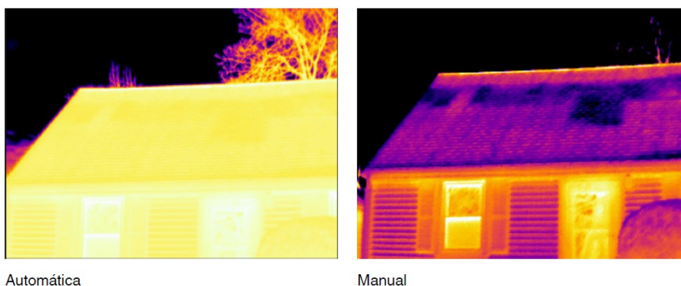
Figura 2. Diferencias entre escalas de temperaturas. Fuente: (FLIR Systems, 2018)
