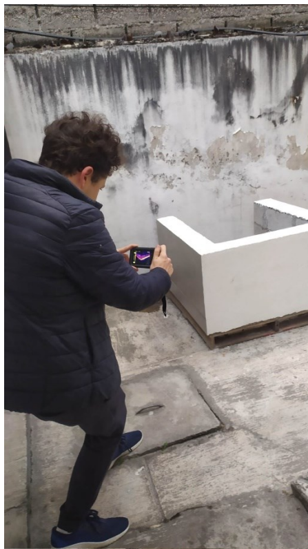
Imagen 26. Medición termográfica en muro de pruebas
