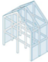
Figura 28. Timber Framing. Elaboración propia.
