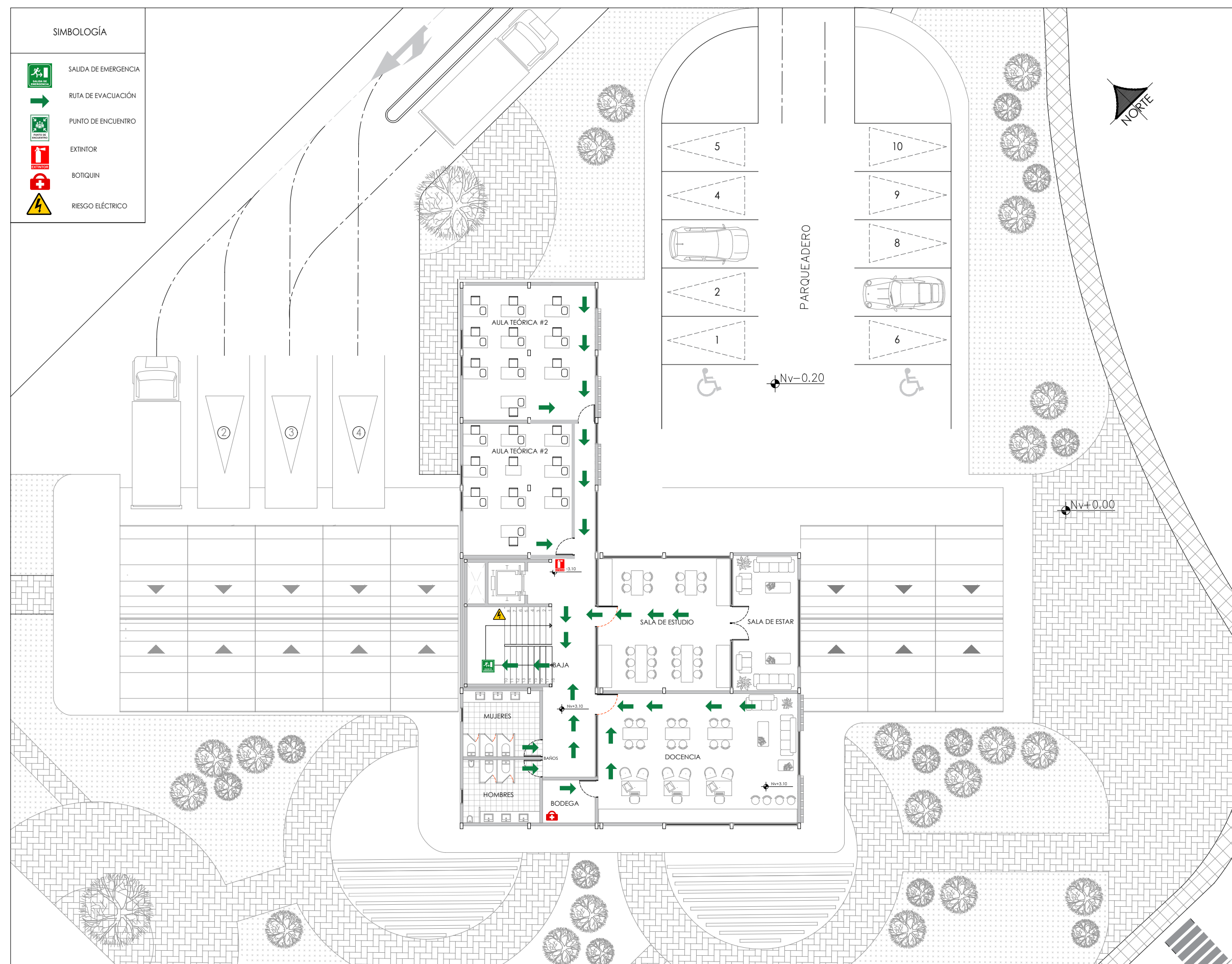
PLANTA DE EVACUACIÓN-Nv+3,10 m
