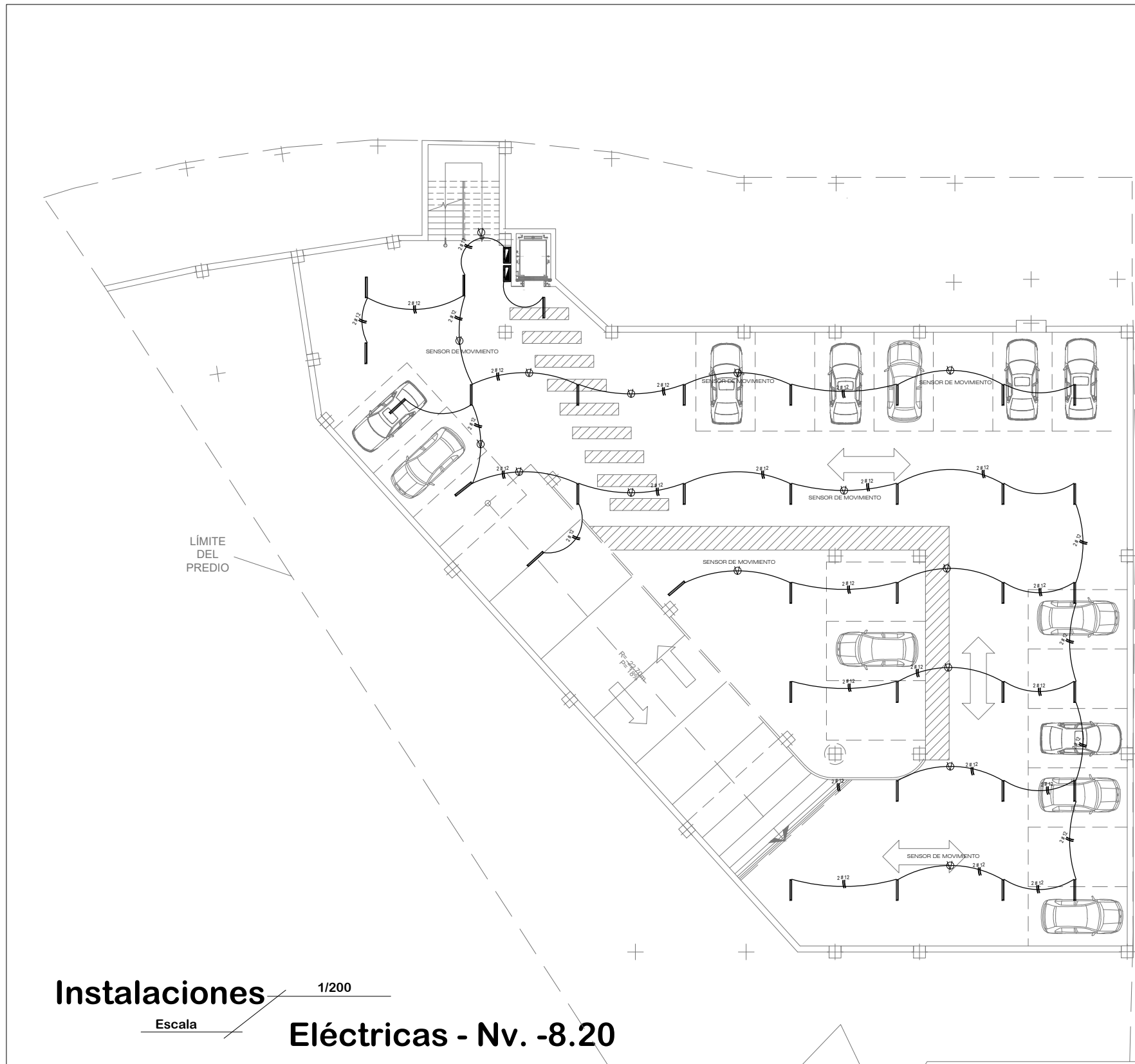
Plano 24. Instalaciones Eléctricas subterráneo 2 Nv. -8.20. Fuente: Elaboración propia, 2021.
