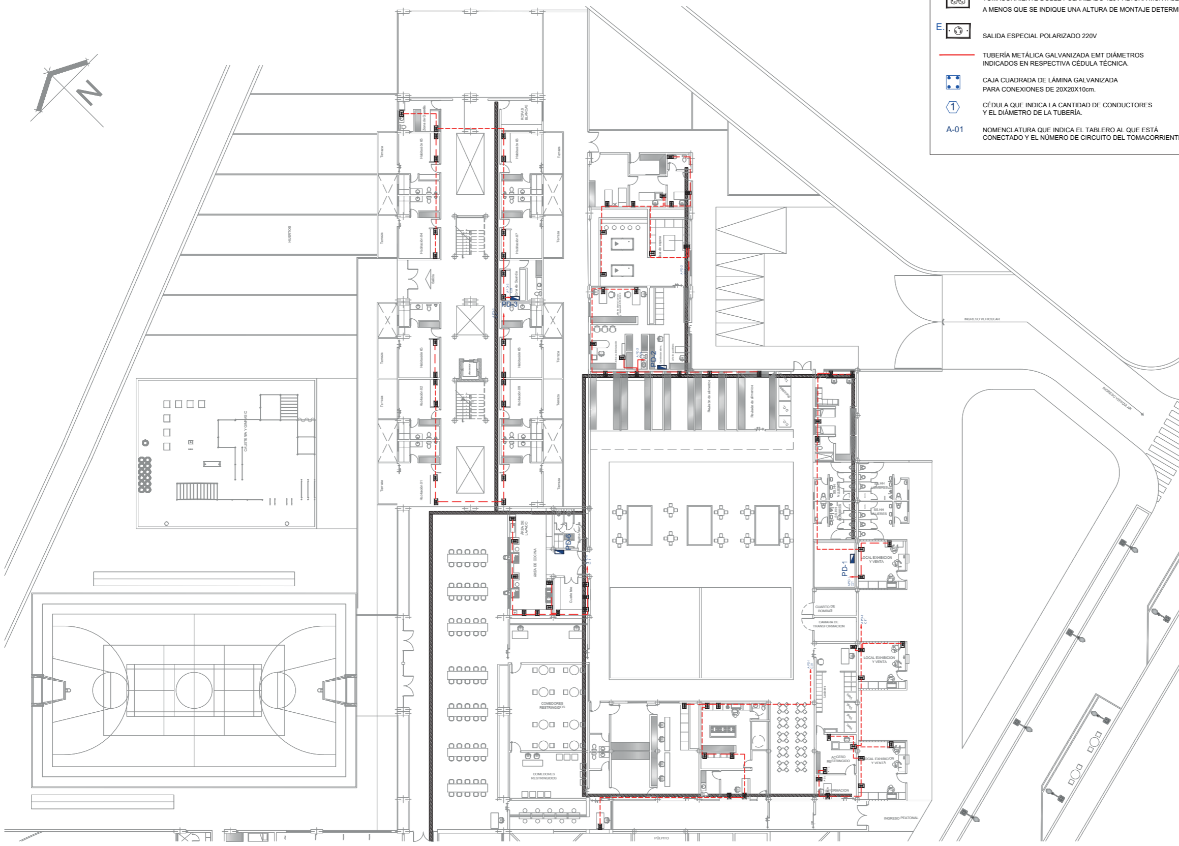
PLANTA BAJA / ZONA A INSTALACION TOMACORRIENTES Escala 1:350
