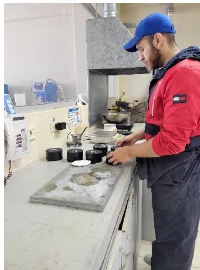
Ilustración 4.1 Determinar peso, diámetro y espesor de cada probeta
