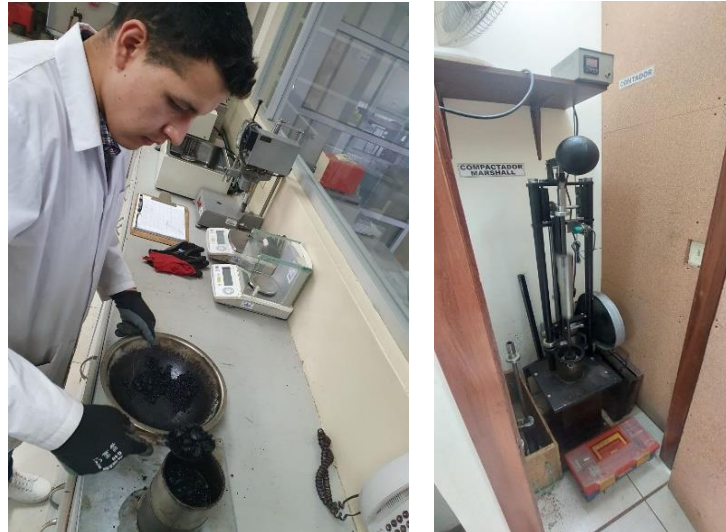
Ilustración 4.7 Colocación del material y posterior ensayo en la compactadora Marshall
