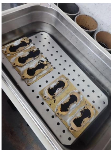
Ilustración 3.3 Ensayo de ductilidad
