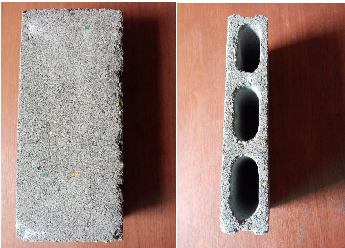
Figura 6: bloque ecológico elaborado con botella PET
