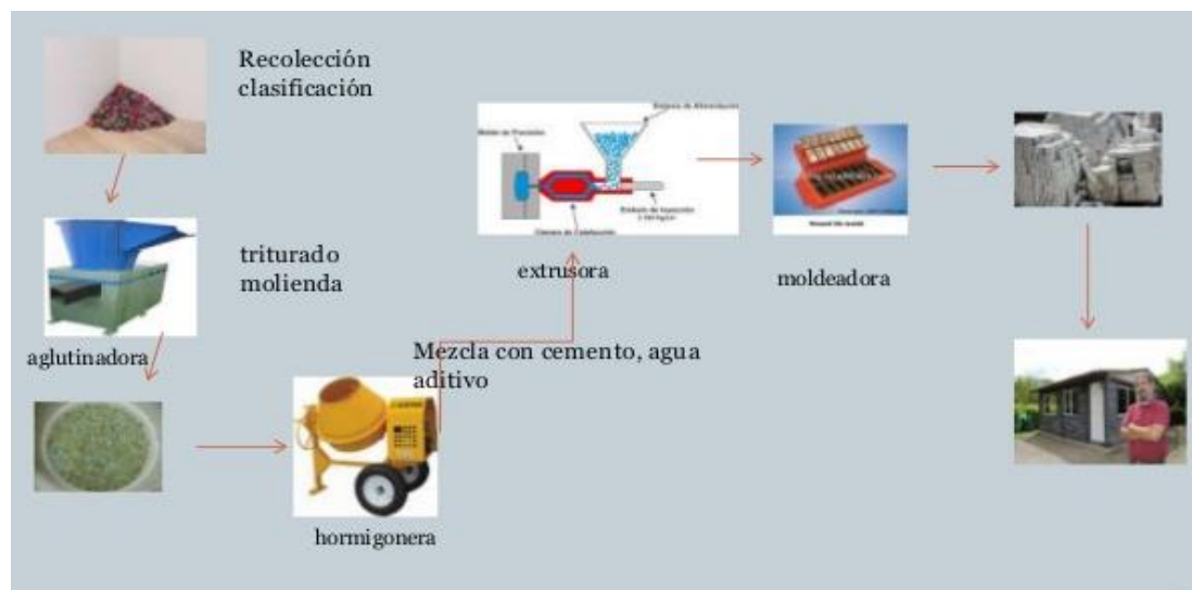
Figura 2: Proceso de fabricación de bloques
