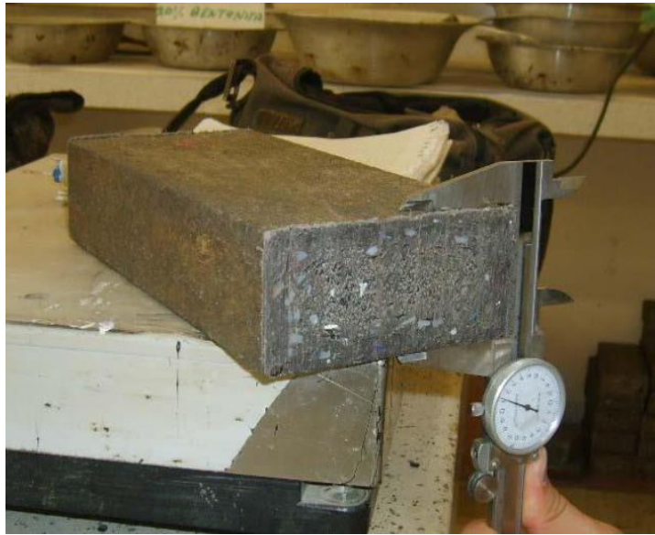
Figura 4: Bloque de hormigón con agregado PET
