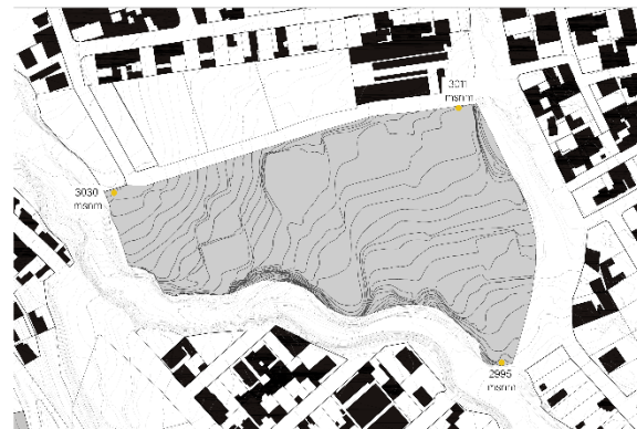
Figura 57. Plano de estructura topográfica y diferencia de niveles en el lote para el CDH Rumiurcu; elaborado por Verdugo, X. 2020
