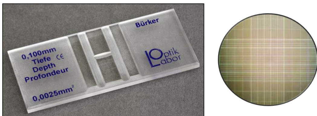
Figura 12. Cámara de Neubauer; Laboratorios PUCESI.
