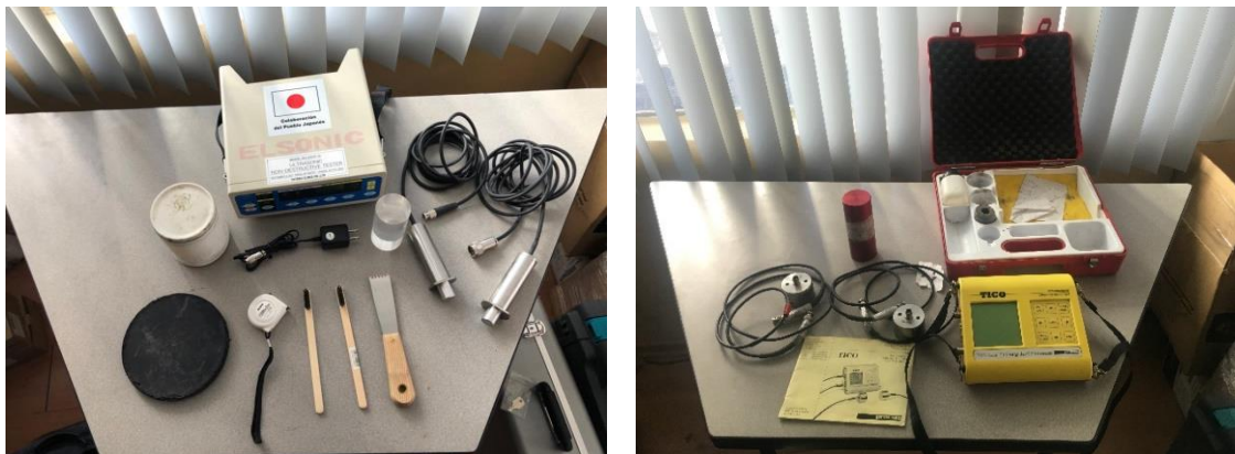
Figura 12. Ultrasonido Elsonic ESI/P-10 y Ultrasonido Tico
