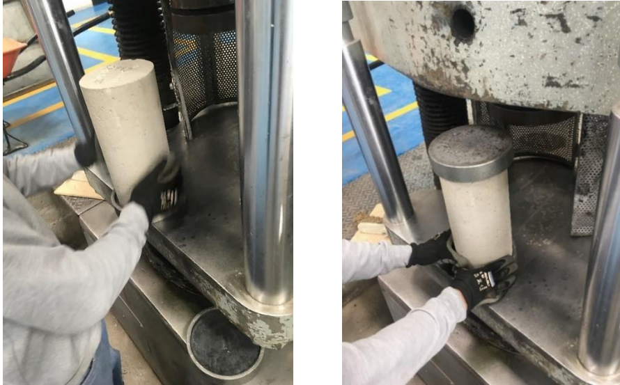
Figura 5. Colocación del Soporte Inferior y Superior
