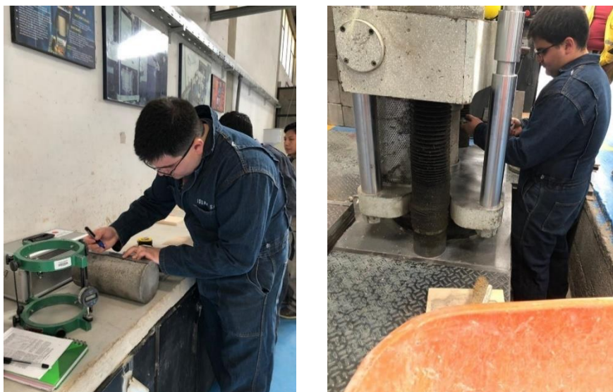
Figura 30. Marcado de Puntos y Ensayo del Esclerómetro
