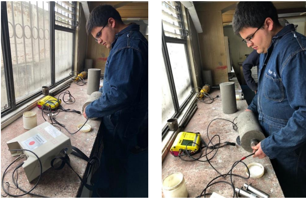
Figura 22. Medición de la Velocidad de Propagación de Onda
