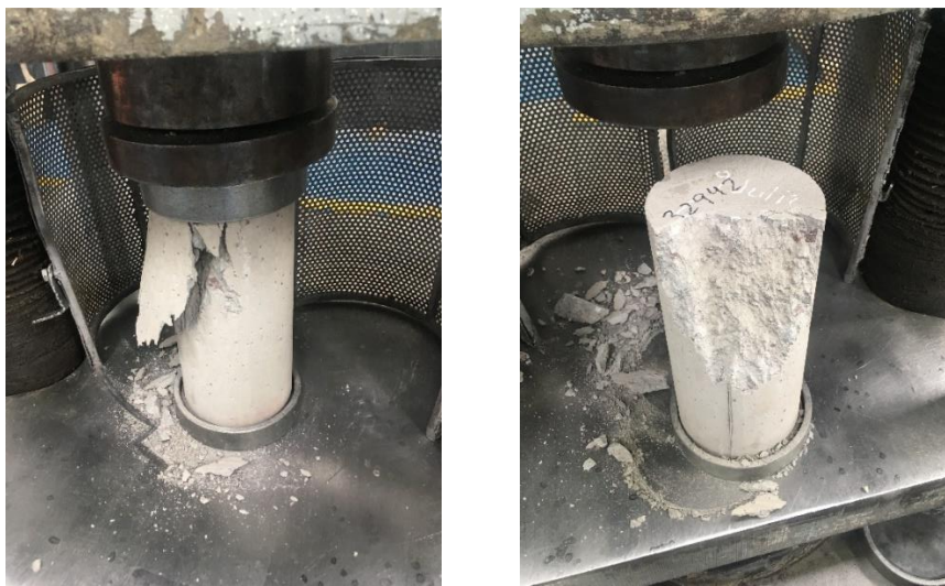
Figura 8. Rotura de Cilindros
