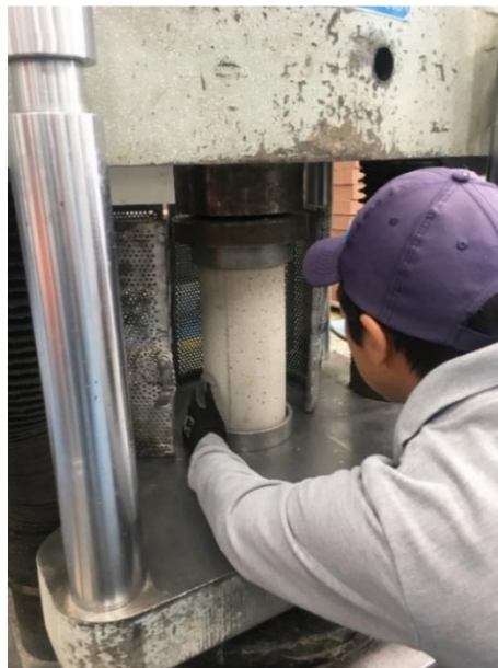
Figura 6. Centrar el Cilindro con el Centro de Empuje
