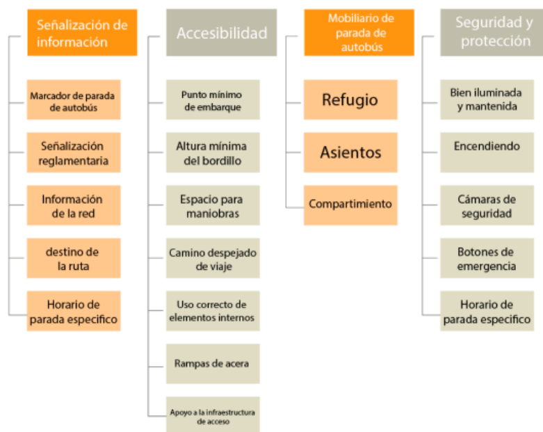
Figura 21. Componentes de una parada de autobús.
