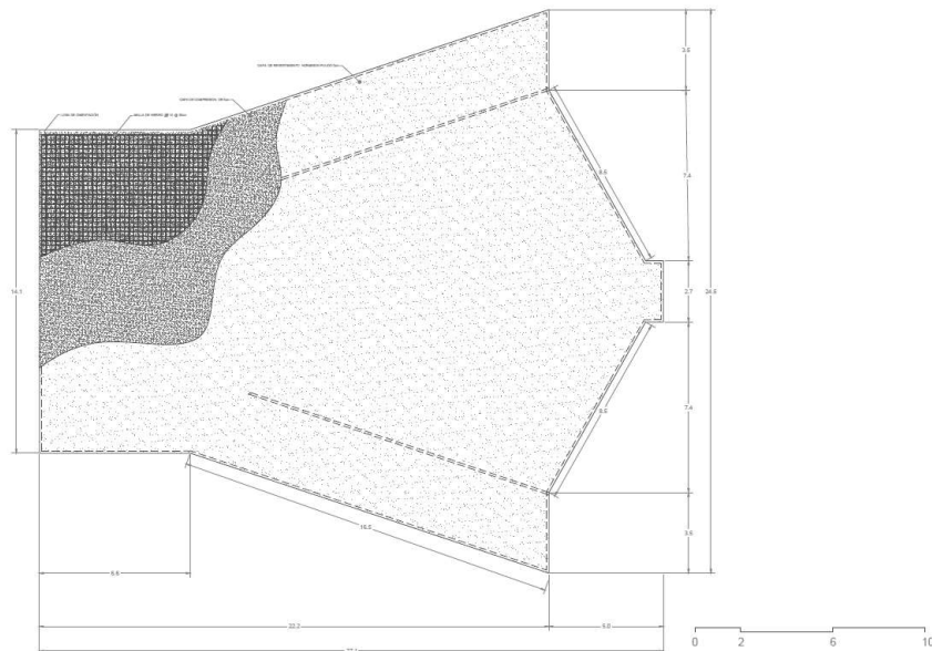
PLANO 3: PLANTA DE CIMENTACIÓN CAPILLA
