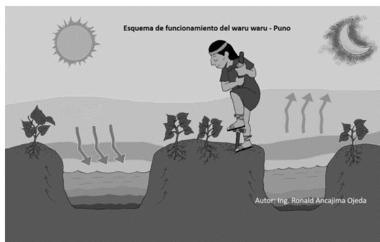
Figura 17: Funcionamiento de Camellones, (Ronald Ancajima, 2013), modificado por Quinatoa J.
