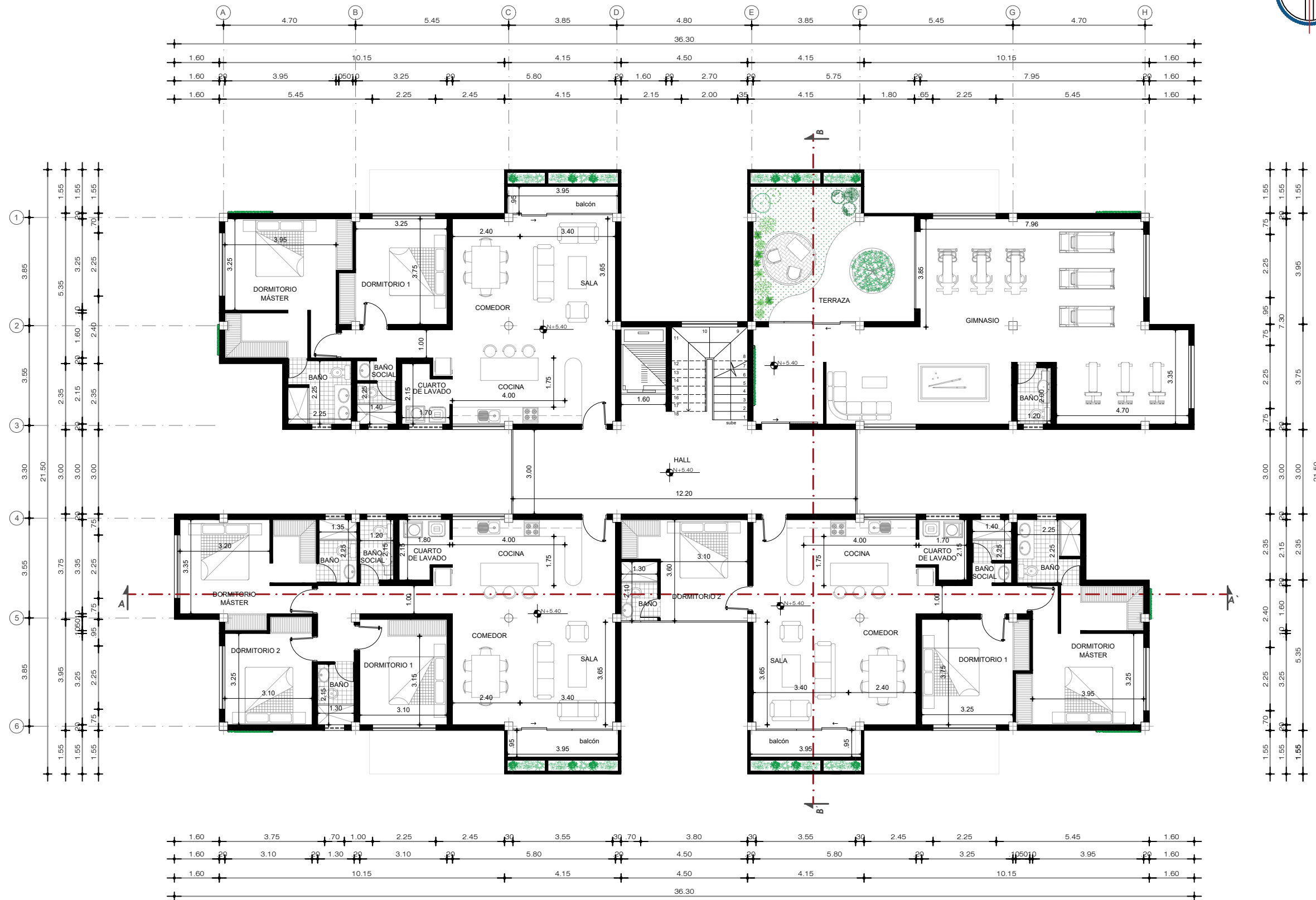
Planta Nv. +5.40 Escala 1:150 EDIFICIO 3
