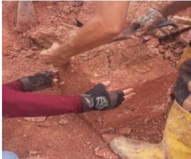
Ilustración 9. Extracción de muestras in situ
