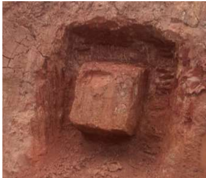
Ilustración 10. Extracción de muestras in situ
